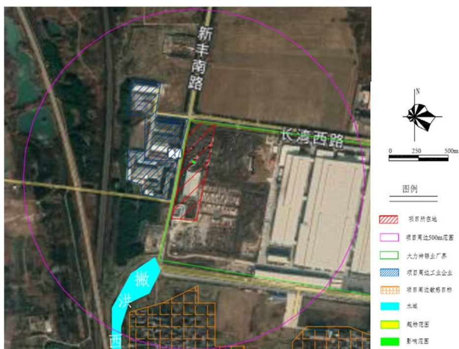
图 6.5.2-1 废水处理站原水罐发生泄漏 100 天 \text{COD}_{\text{Mn}} 的超标及影响范围
