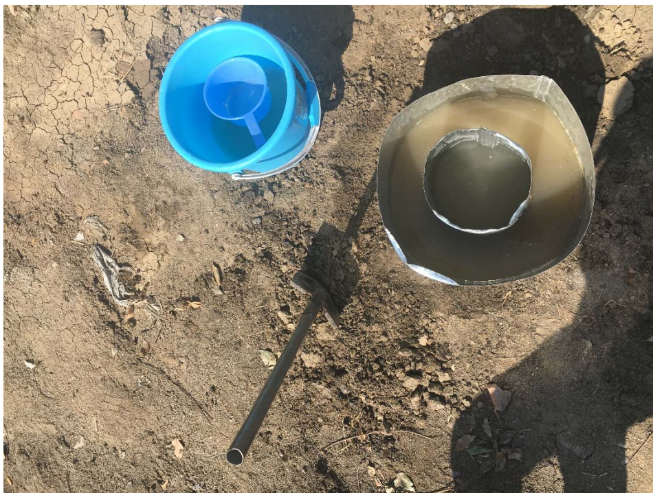
图 6.5.1-4 渗水试验现场照片
