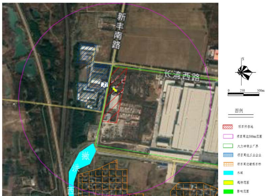
图 6.5.2-2 废水处理站原水罐发生泄漏 1000 天 \text{COD}_{\text{Mn}} 的超标及影响范围
