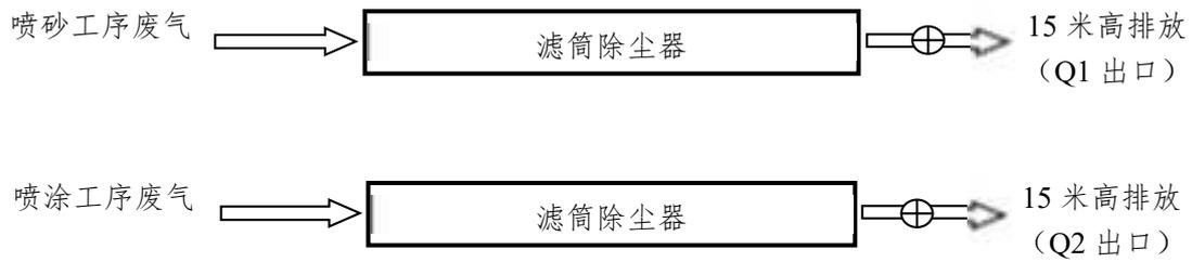
图3-1 有组织废气排放示意图
