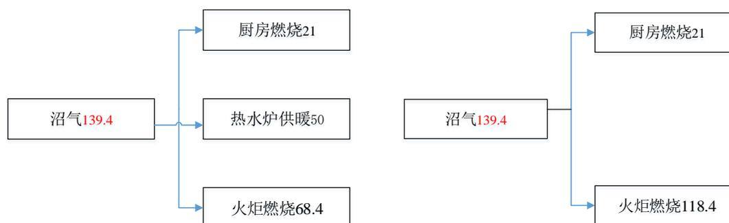
图 3.4-2 秋冬季沼气平衡 (单位: m<sup>3</sup>/d)      图 3.4-3 春夏季沼气平衡 (单位: m<sup>3</sup>/d)
